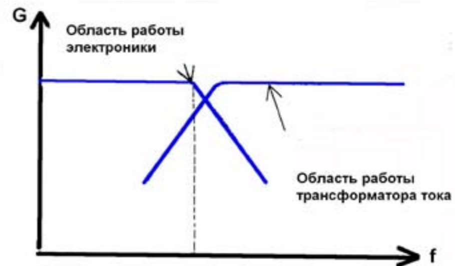
Рис.3. При увеличении рабочей частоты датчик работает как трансформатор тока.
